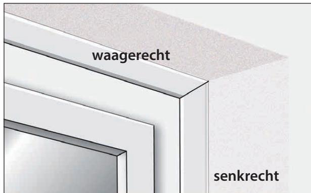
2. Dichtleisten (rotes Schaumklebeband innen, grünes Schaumklebeband außen) oben und seitlich passend zum Bauelement ablängen. Eventuelle Eckverbindungen mittels Gehrungsschere auf Gehrung schneiden, oder alternativ stumpf stoßen.
